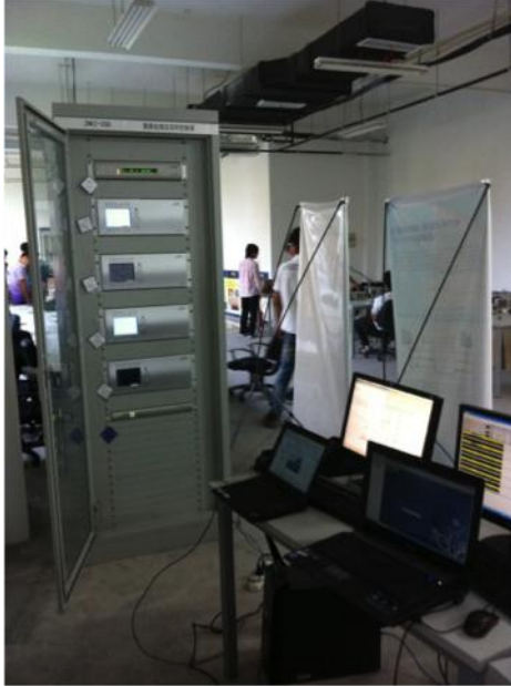
图 3.8 广域阻尼控制器抑制频率振荡实验所用仿真环境 (a) 硬件接口设备 (b) 电力系统 TH-STBLT 仿真平台 (c) 通讯网仿真平台
